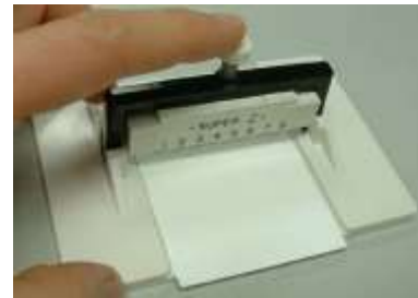
Τοποθέτηση των δειγμάτων στην επιφάνεια του gel
