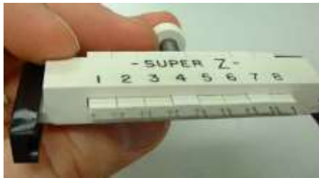
Χρήση του εφαρμογέα super Z για δέσμευση του δείγματος
